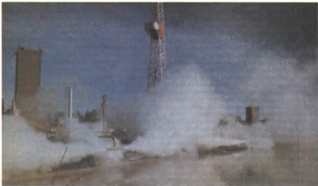
Первая в мире циркуляционная система с гидро-разрывом горячих гранодиоритов. Полигон Фентон Хил, Лос-Аламосская национальная лаборатория (США)
